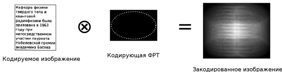
Рис. 1. Схема процесса оптического кодирования с временным интегрированием
