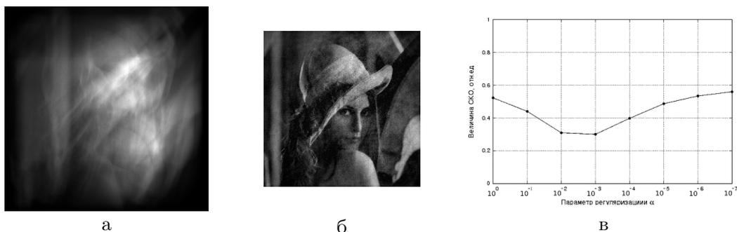
Рис. 10. Кодирование и восстановление стандартного полутонового тестового изображения: (а) оптически кодированное изображение; (б) наилучшее по СКО восстановленное изображение; (в) зависимость СКО от параметра регуляризации при восстановлении
