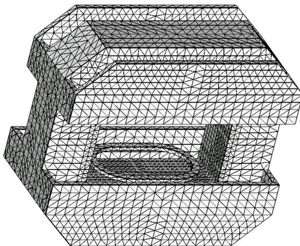
Рис. 1. Разбиение магнита на тетраэдры
