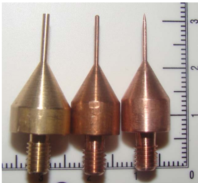
Рис. 5. Формы электродов (сменные аноды), использовавшиеся в эксперименте
