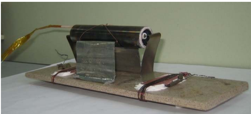
Рис. 3. Галогенная лампа накаливания внутри цилиндрического контейнера
