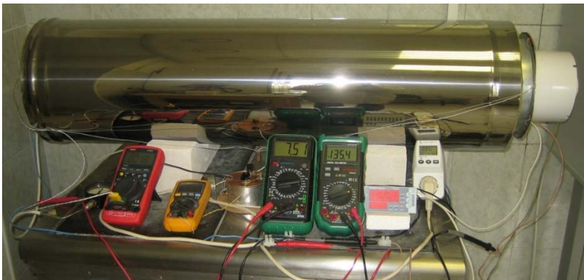
Рис. 4. Воздушный проточный калориметр
