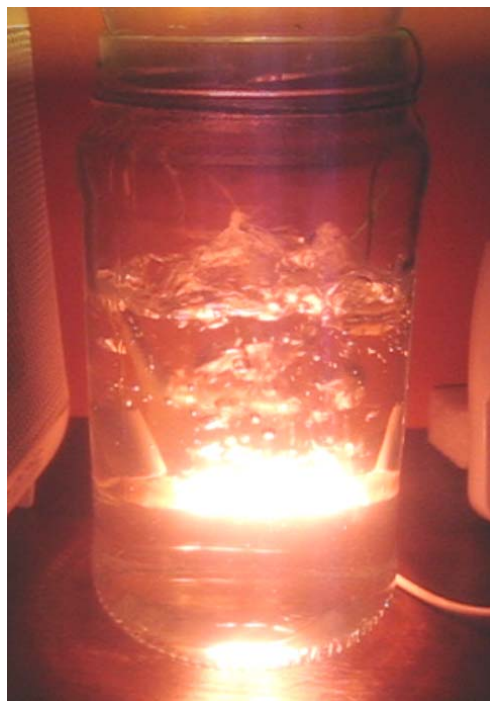
Рис. 8. Галогенная лампа накаливания в кипящей воде с суспензией NaBiO 3
