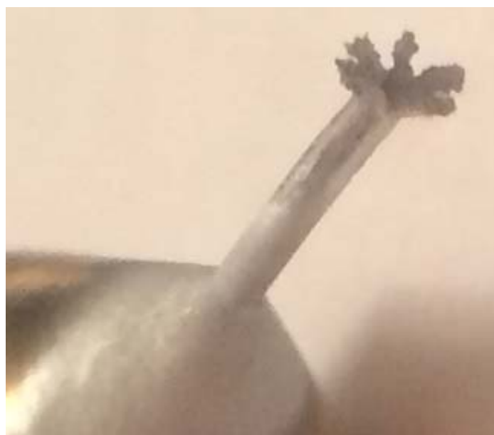
Рис. 10. Белый налет, образующийся на поверхности анода в ходе электрического разряда
