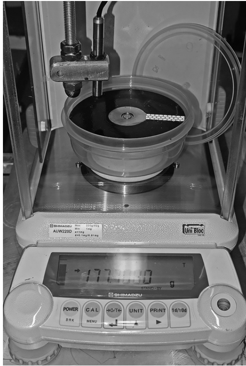
Рис. 9. Диск-гироскоп в полиэтиленовом контейнере на весах, крышка от контейнера рядом; над диском датчик измерения скорости
