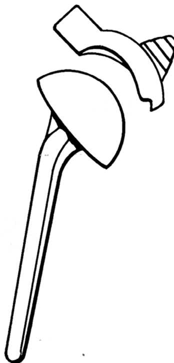
Рис. 3 Эндопротез DANA – Designed After Natural Anatomy
