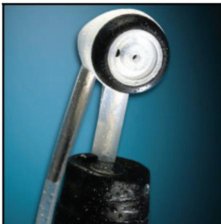
Рис. Датчик «Vireg» для измерения давления в ВРВП
