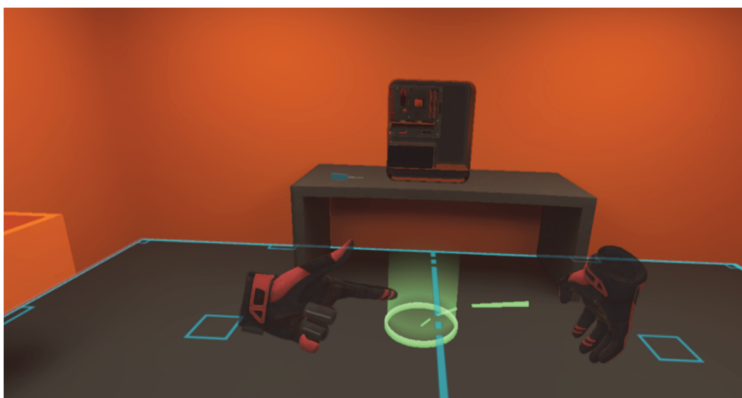
Рис. 6. Перемещение по сцене с помощью телепортации Figure 6. Moving around the stage using teleportation
