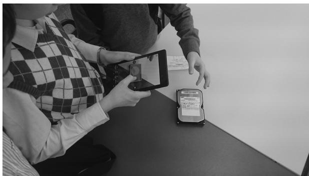
Рис. 1. Виртуальная модель строения жесткого диска отображается системой дополненной реальности на реальном жестком диске
