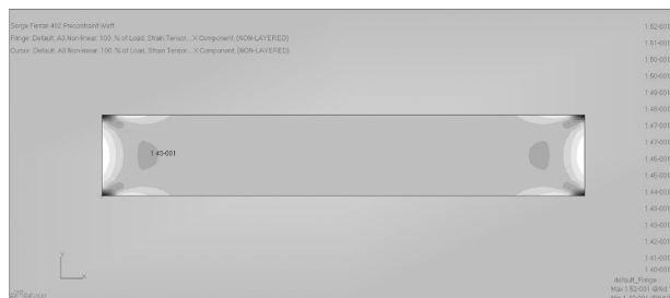
Рис. 9. Деформации материала Serge Ferrari 402 Precontraint в направлении утка [Warp material Serge Ferrari Precontraint 402 in the weft direction]
