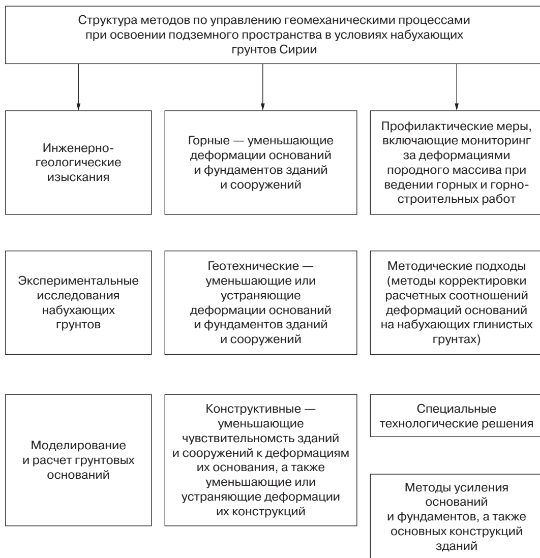
Рис. Структура методов по управлению геомеханическими процессами при освоении подземного пространства в Сирии в условиях набухающего грунтово-породного массива [Structure of methods for management of geomechanical processes during the development of underground space in Syria in the conditions of swelling soil-rock mass]
