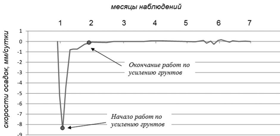
Рис. 5. Скорости осадков деформационных марок [Speed sediment deformation signs]
