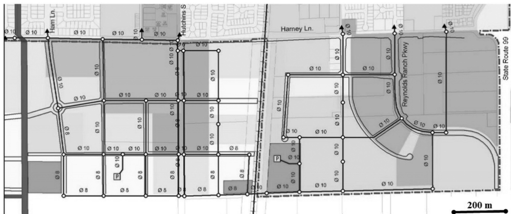
Рис. 1. Проектируемые водопроводные сети г. Лоди [Projected water supply systems in the city of Lodi]
