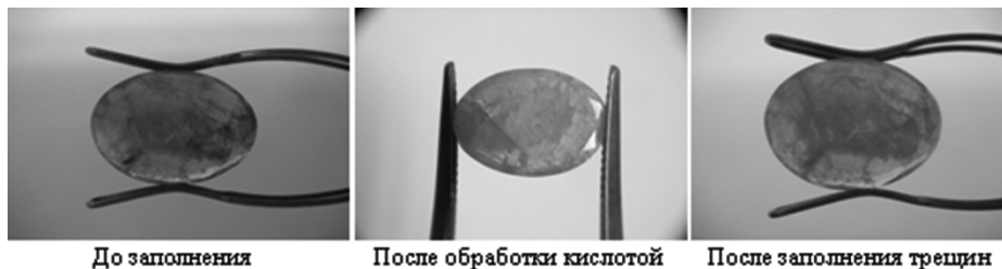
Рис. 4. Ограненный изумруд до и после облагораживания [4]
