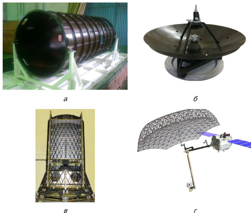
Рис. 1. Космические конструкции из КМ: а — размеростабильная несущая конструкция объектива оптико-электронного комплекса [1]; б — антенна, состоящая из двух тонких композитных оболочек [2]; в — корпус КА Экспресс-2000 [3]; г — КА системы «КондорФКА»
