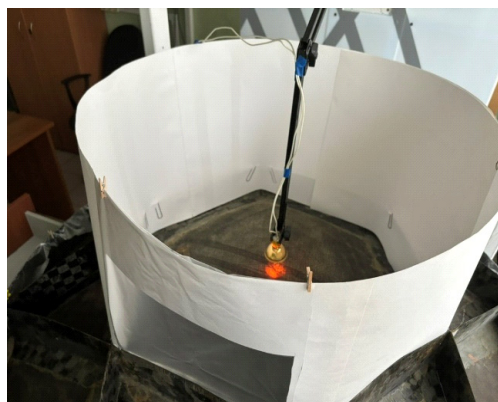
Рис. 9. Камеры спокойного воздуха: a — на радиоотражающей стороне рефлектора; б — на тыльной стороне рефлектора Источники: выполнено И.А. Ефременко, О.В. Денисовым, Л.В. Денисовой.
