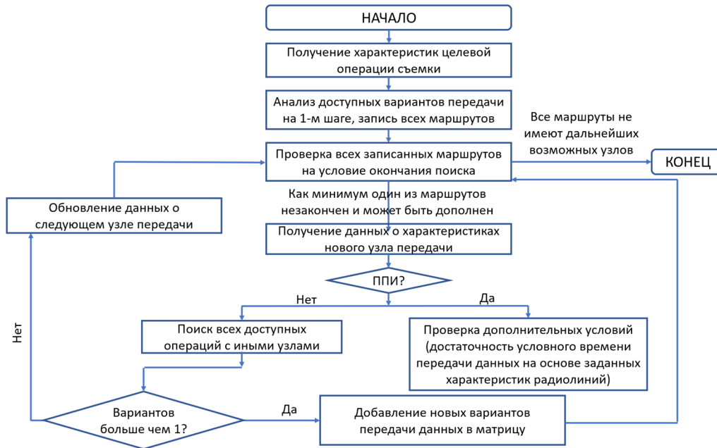
Рис. 4. Блок-схема алгоритма ретрансляции данных на ППИ
