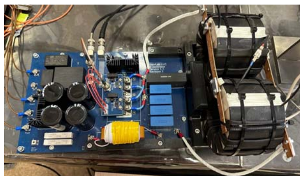
Рис. 5. Фотография разработанного высоковольтного генератора с импульсным трансформатором Источник: фото К.А. Сергушичева
