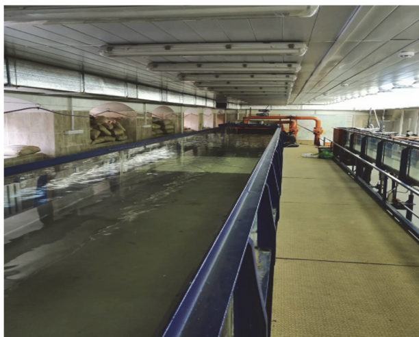
Рис. 1. Гидравлический стенд для проведения модельных испытаний на физической модели Figure 1. Hydraulic bench for conducting physical model tests
