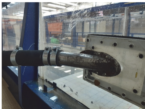
Рис. 2. Монтаж патрубка к стенке гидравлического лотка: а – общий вид крепления патрубка к стенке; б – один из вариантов сопряжения патрубка к стенке лотка под углом 30^\circ Figure 2. Nozzle to hydraulic tray wall mount: а – general view of nozzle attachment; б – an option for nozzle to wall mount at 30^\circ angle
