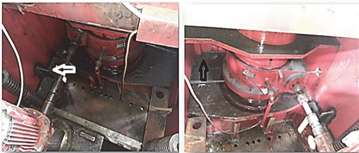
**Рис. 2.** Трещины в ползуне, выявленные в процессе обследования (фото Чжо Заяр)
