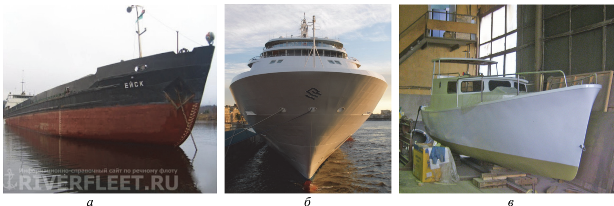
Рис. 1. Формы судовых корпусов: а – грузовое судно; б – пассажирское судно; в – корпус строящейся яхты (фотографии б и в С.Н. Кривошапко, В.Н. Иванова)
