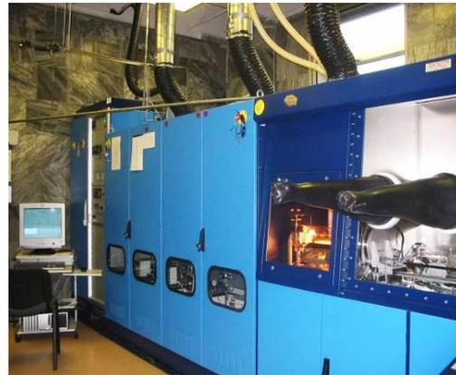
**Рис. 2.** MOCVD технология каскадных гетероструктур для фотоэлектрических преобразователей (ФТИ имени А.Ф. Иоффе)
