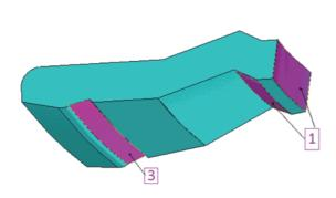
**Puc. 5.** Контактные поверхности прижима [**Figure 5.** Contact surfaces of a clamp]
