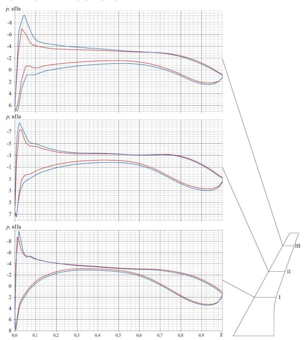
**Рис. 4.** Распределения давления  $p(\overline{x})$  по профилю крыла при угле атаки  $\alpha = 0^\circ$ : недеформированное (——) и деформированное (——) крылья
