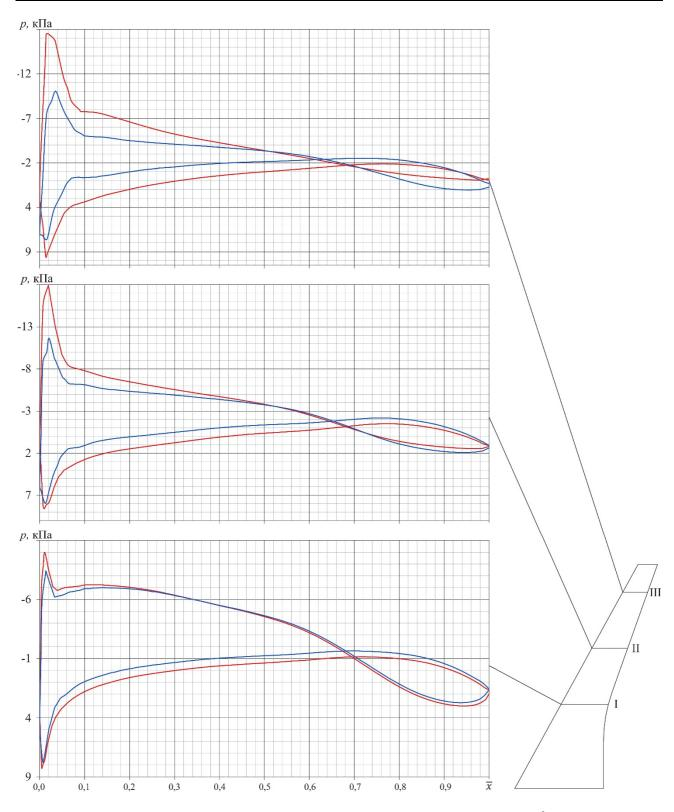
**Рис. 6.** Распределения давления  $p(\overline{x})$  по профилю крыла при угле атаки  $\alpha = -7^\circ$ : недеформированное ( —— ) и деформированное ( —— ) крылья
