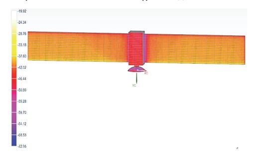
**Рис. 2.** Температурное поле в конструкции КА под влиянием нагрева потоками теплового излучения от Солнца в период зимнего солнцестояния и Земли (теневая часть витка), °C [**Figure 2.** The temperature field in the spacecraft structure under the influence of heating by thermal radiation fluxes from the Sun during the winter solstice and the Earth (shadow part of the orbit), °C]
