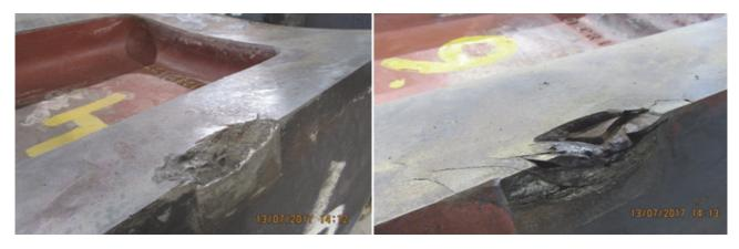
**Рис. 2.** Разрушение секторов в области их контакта между собой [**Figure 2.** Destruction of sectors in the area of their contact with each other]
