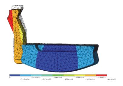
**Puc. 10.** Перемещения сектора и прижима в радиальном направлении, м [**Figure 10.** Sector and clamp movements in the radial direction, m]
