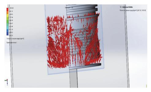
**Puc. 4.** Моделирование процесса работы поршня с формированным макропрофилем на рабочей поверхности юбки [**Figure 4.** Modeling of the piston operation with the formed macro profile on the working surface of the skirt]
