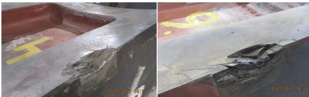
**Рис. 2.** Разрушение секторов в области их контакта между собой
