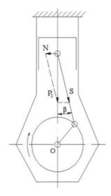
Рис. 2. Разложение суммарной движущей силы в кривошипно-шатунном механизме
