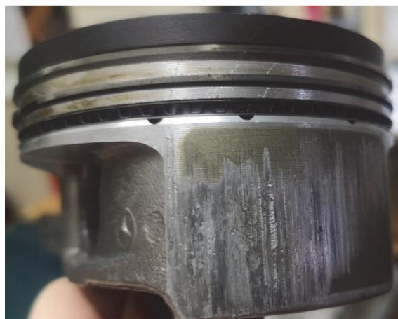
**Рис. 3.** Износ антифрикционного покрытия на юбке поршня
