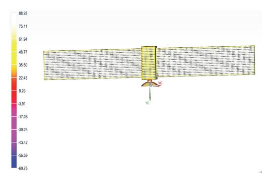
Рис. 3. Температурное поле в конструкции КА под влиянием нагрева потоками теплового излучения от Солнца в период весеннего равноденствия и Земли (освещенная часть витка) на освещенной стороне KA, °C [Figure 3. The temperature field in the spacecraft structure under the influence of heating by thermal radiation flux from the Sun during the spring equinox and the Earth (the illuminated part of the orbit) on the lightened side of the spacecraft, °C]
