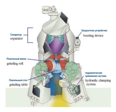
**Puc. 1.** Конструкция исследуемой валковой мельницы [**Figure 1.** The design of the investigated roller mill]
