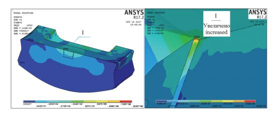
**Рис. 9.** Эквивалентные напряжения, Па [**Figure 9.** Equivalent stresses, Pa]
