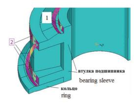
**Puc. 4.** Контактные поверхности втулки подшипника и кольца [**Figure 4.** Contact surfaces of bearing sleeve and ring]
