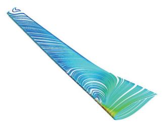
**Рис. 7.** Направление потока вблизи поверхности крыла при угле атаки +11°, зоны образования завихрений [**Figure 7.** Airflow streamlines near the wing surface at an angle of attack of +11°, the zone of formation of vortices]
