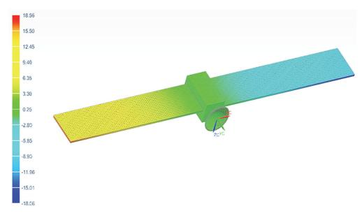
**Puc. 4.** Общие перемещения в конструкции КА под влиянием нагрева потоками теплового излучения от Солнца в период зимнего солнцестояния и Земли (освещенная часть витка), мм
