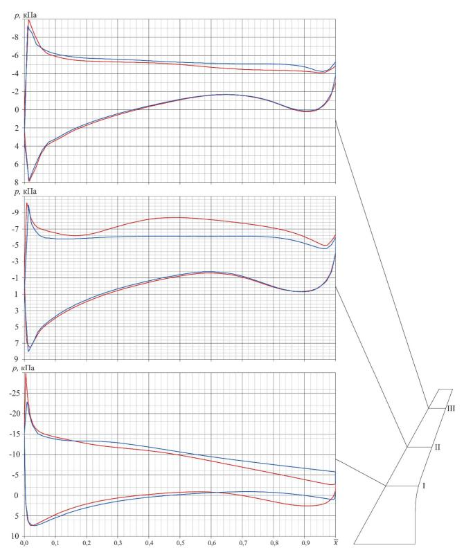
**Рис. 5.** Распределения давления  $p(\overline{x})$  по профилю крыла при угле атаки  $\alpha = +11^\circ$ : недеформированное (——) и деформированное (——) крылья
