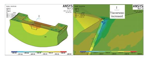
**Рис. 8.** Первое главное напряжение, Па [**Figure 8.** The first main stress, Pa]
