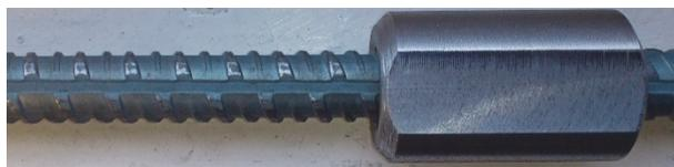
**Рис. 6.** Общий вид четырехрядной винтовой арматуры (фотография сделана Г.И. Тихоновым)
