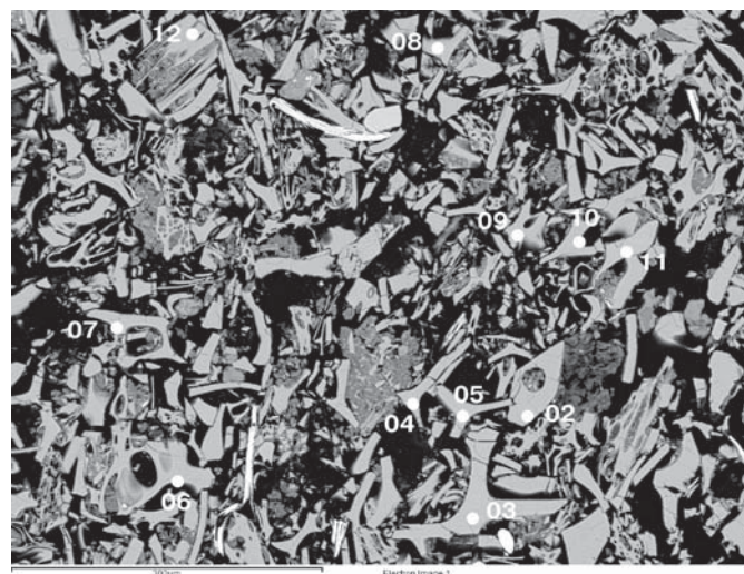
Рис. 4. Микрофотография пепла риолитового витрокластического в отраженных электронах.
