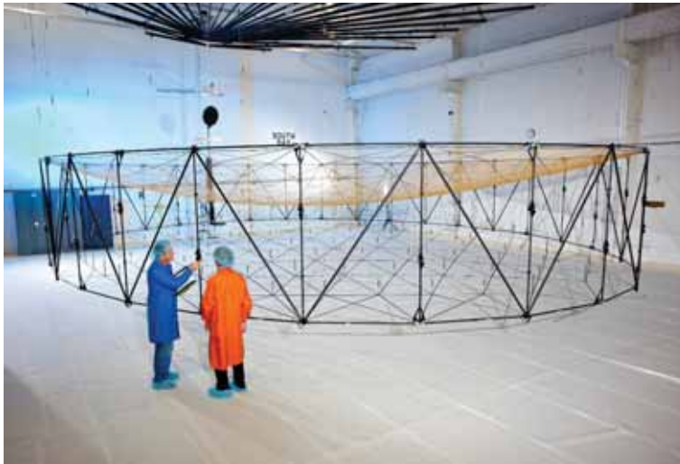
Рис. 1. Рефлектор космической антенны вантово-ободной схемы фирмы Astro Aerospace [Figure 1. Cable-rim scheme space antenna reflector of the Astro Aerospace Company]
