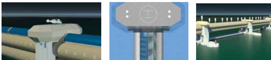
Рис. 5. Фрагменты инженерного решения моста: а, б — вертолетная эвакуационно-смотровая площадка на быках; в — установка ветрогенераторов и солнечных батарей на мостовых конструкциях [ Figure 5. Fragments of the bridge engineering solution: а, б — helicopter evacuation and observation deck on the bulls supports; в — installation of wind turbines and solar panels on bridge structures]
