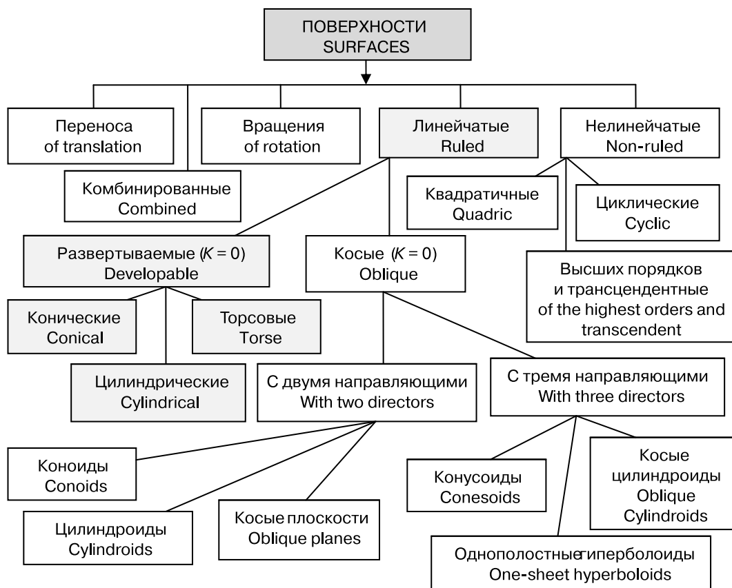
Рис. 2. Классификация поверхностей по методу их формирования [Figure 2. Classification of surfaces with taking into account a method of their forming]
