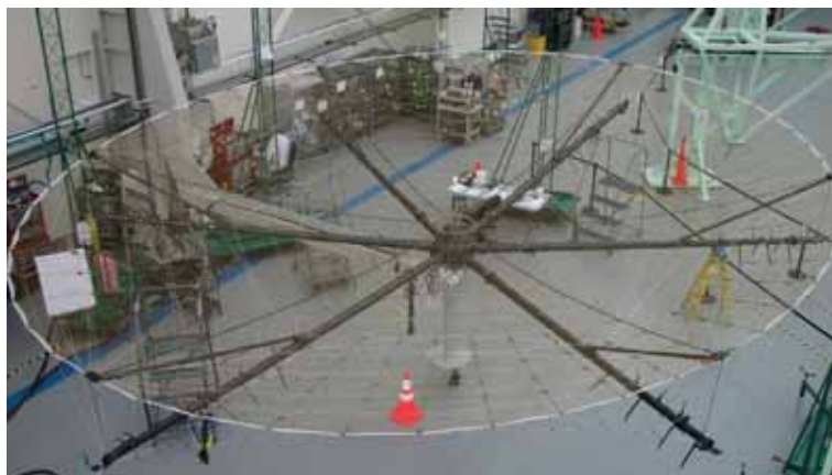
Рис. 2. Рефлектор космической антенны зонтичной схемы фирмы Harris [ Figure 2. Umbrella type reflector of the space antenna, Harris Company]
