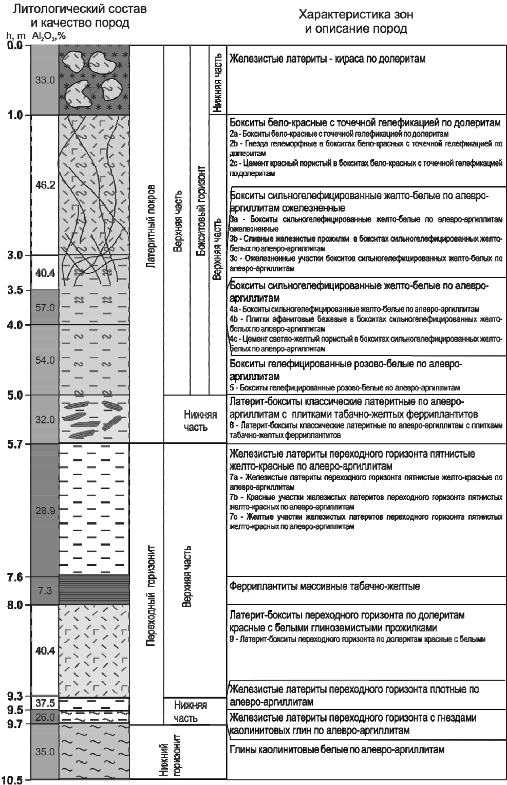
Рис. 2. Типичный разрез коры выветривания месторождений рудного поля Кулоре [Fig. 2. Typical residuum section of deposits in the Koulore ore field]
