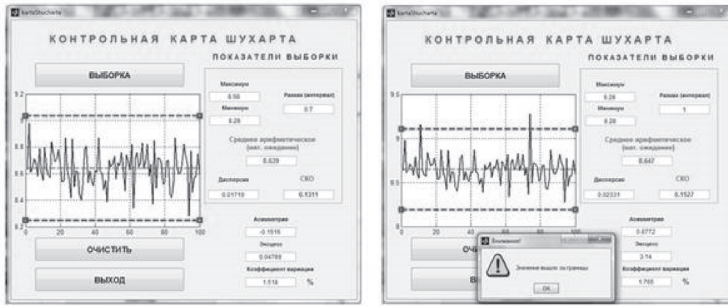
Рис. 4. Программа вычисления статистических показателей для контроля качества выпускаемой продукции [Fig. 4. Program for calculating statistical parameters for product quality control]
