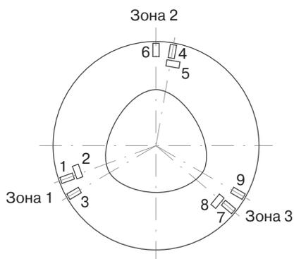
**Рис. 2.** Схема расположения тензодатчиков
