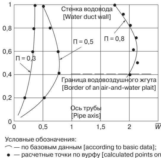
**Рис. 2.** Распределение безразмерной тангенциальной скорости в выходном сечении водовода
