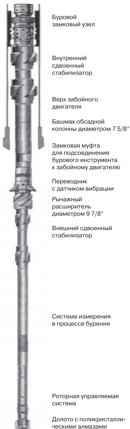
Рис. 1. Забойная компоновка для наклонно направленного бурения на обсадных трубах [Fig. 1. Bottom-hole assembly for directional casing drilling]
