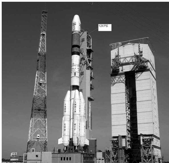
**Рис. 6.** Ракета-носитель GSLV с криогенным разгонным блоком «12КРБ»
