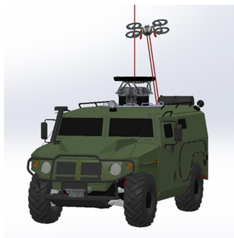
Рис. 1. Взаимное расположение БПЛА и ВПУ
