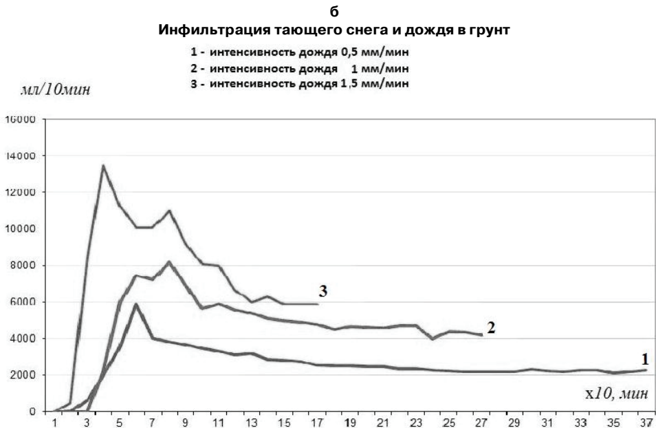
Рис. 1. Инфильтрация тающего снега: а) инфильтрация талой воды в грунт (по данным лабораторных измерений); б) инфильтрация талой и дождевой воды в грунт при воздействии дождя на процесс таяния снега
