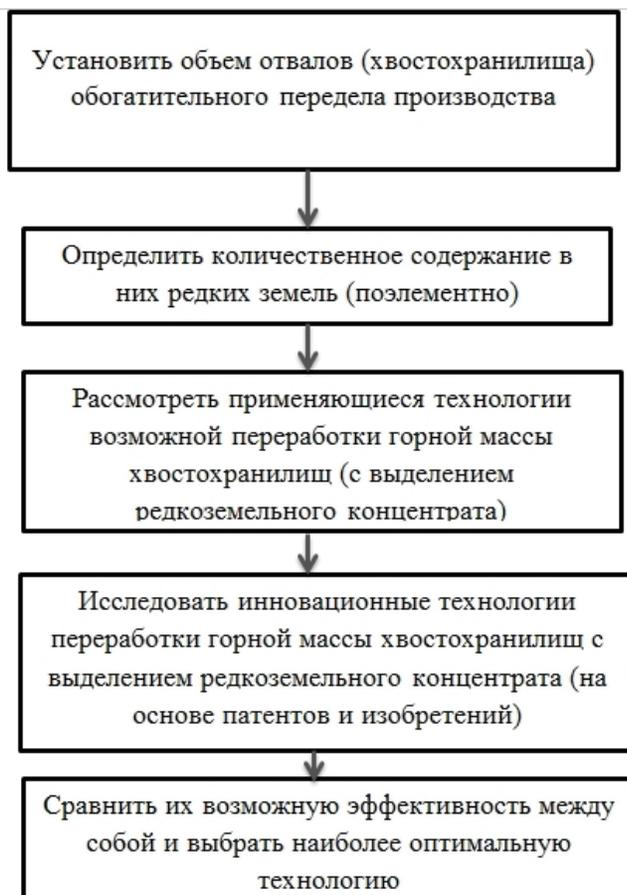
Рис. 1. Методика аудита оценки эффективности технологии переработки отвалов для извлечения редких металлов
