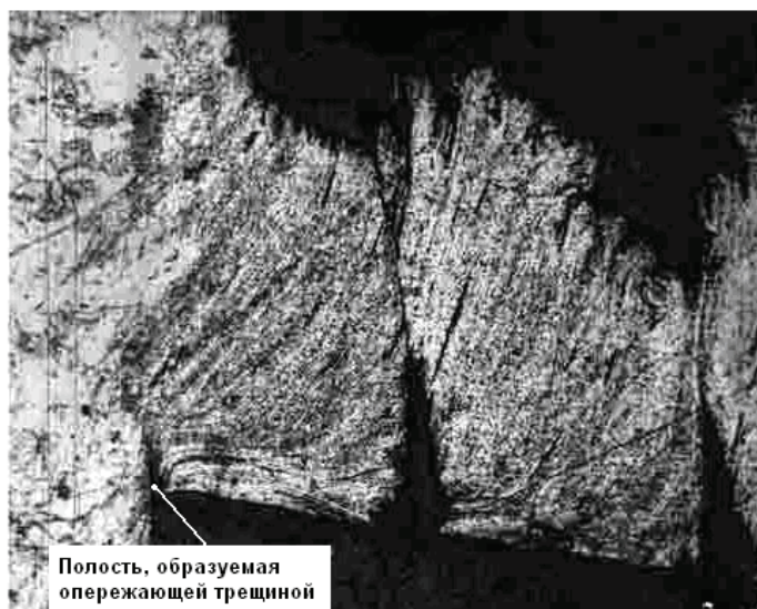
Рис. 7. Пример микрошлифа корня стружки с опережающей трещиной
