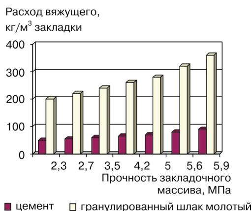
**Рис. 1.** Зависимость расхода вяжущего в составе закладочной смеси от необходимой прочности закладочного массива в возрасте 360 суток
