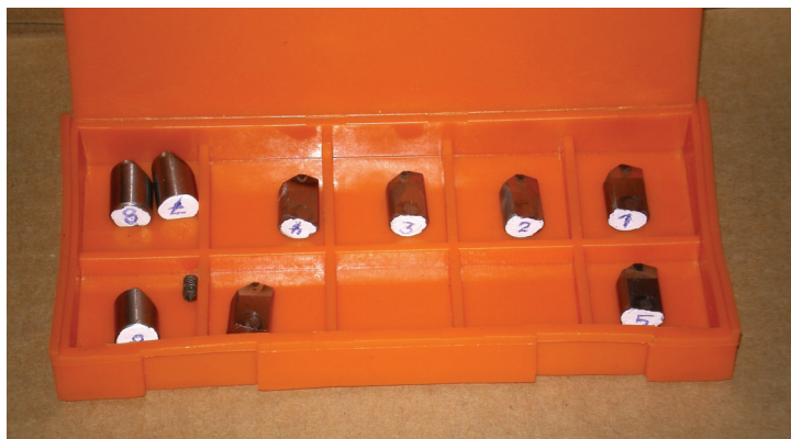
Рис. 2. Внешний вид резцовых вставок
