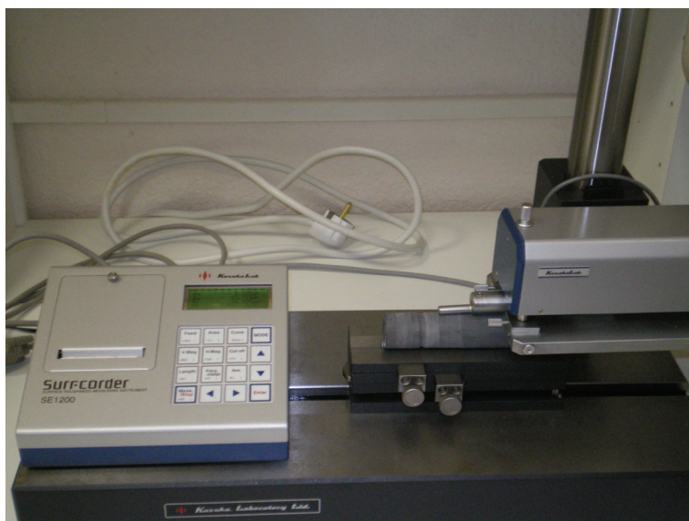
Рис. 5. Измерение шероховатости обработанной поверхности
