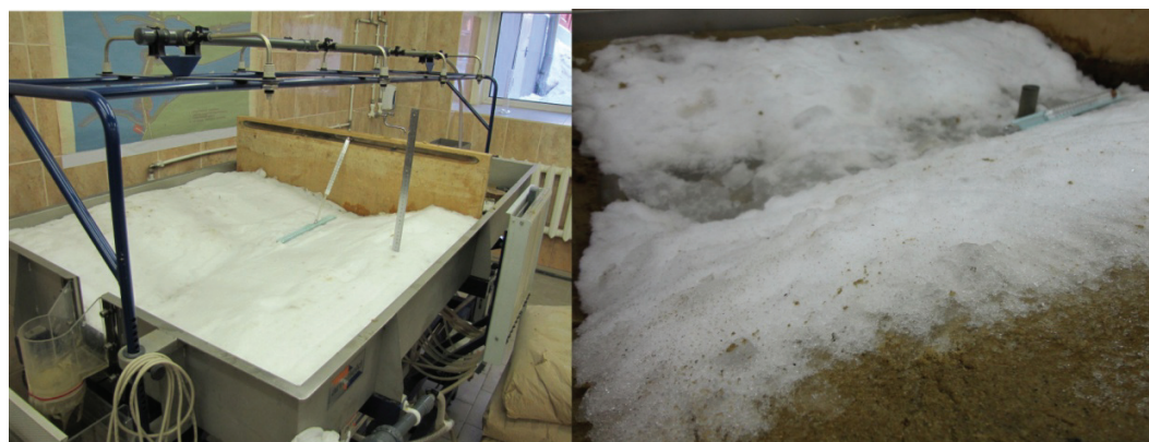
Рис. 2. Установка для измерения инфильтрационных потоков
