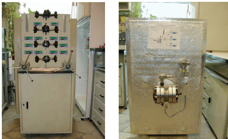
Рис. 5. Установка исследования газогидратов «Газогидрат-3М»
