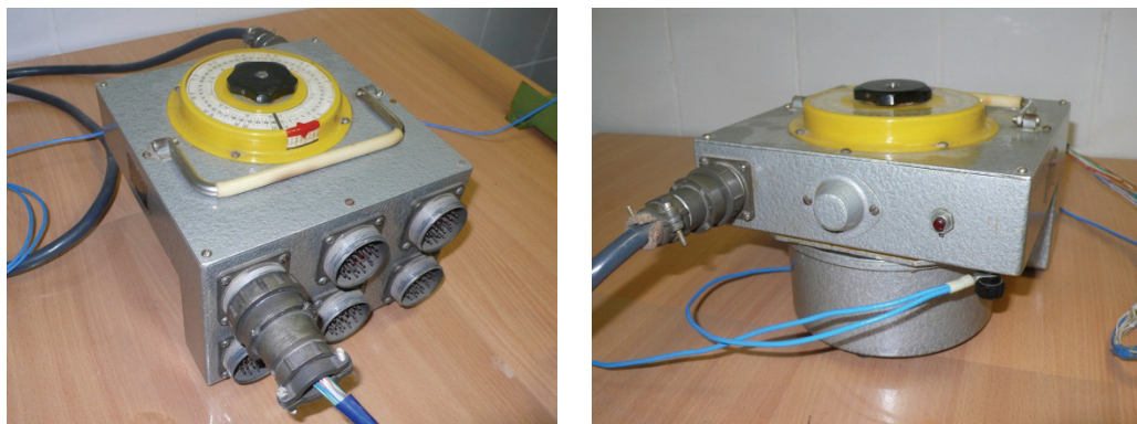
Рис. 4. Автоматический 100-позиционный прецизионный переключатель АП-3
