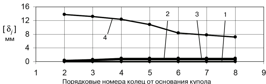
Рис. 7. Графики предельных меридиональных зазоров в соединяемых узлах блоков
