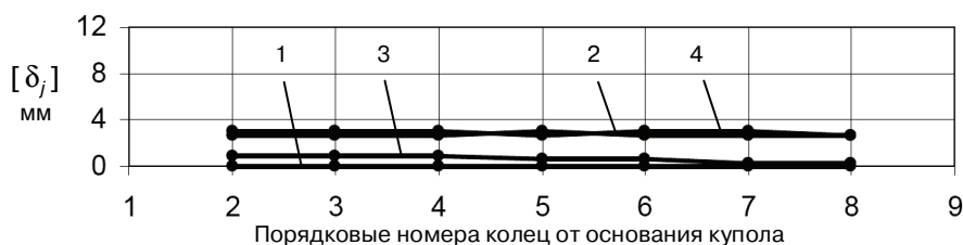
Рис. 5. Графики предельных нормальных зазоров в соединяемых узлах блоков
