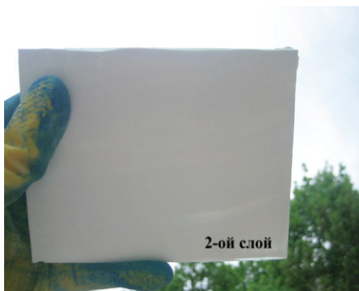
Рис. 2. Нанесение второго слоя воднодисперсионной краски ВД-АК-114
