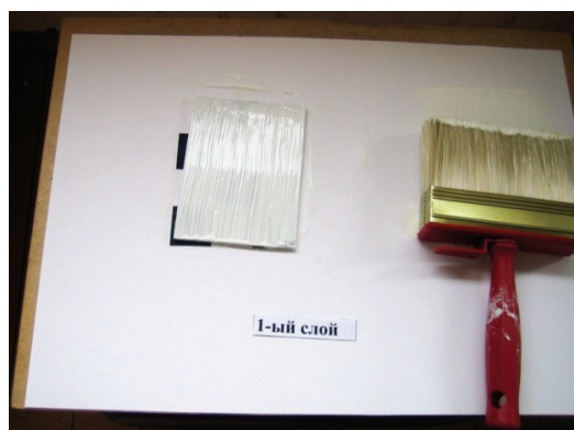
Рис. 1. Нанесение первого слоя воднодисперсионной краски ВД-АК-114
