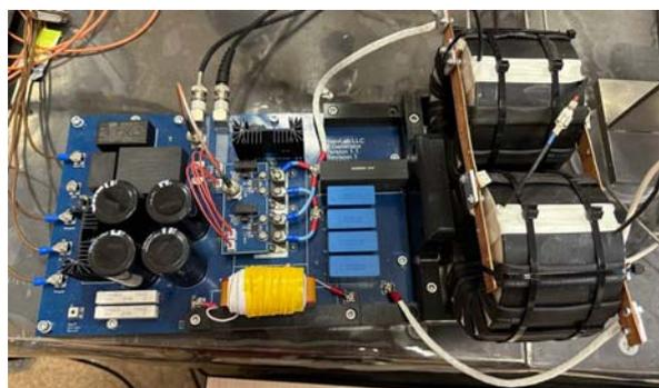
**Рис. 5.** Фотография разработанного высоковольтного генератора с импульсным трансформатором
