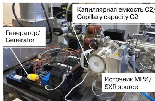
**Рис. 6.** Фотография разработанного высоковольтного генератора в составе источника мягкого рентгеновского излучения (МРИ)
