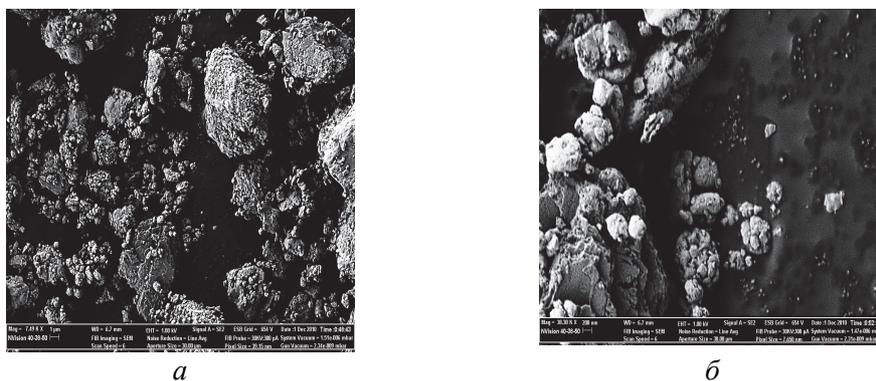
Рис. 2. УДП оксидов алюминия и кремния при различном увеличении: а –  $\times 7500$ ; б –  $\times 38\,300$
