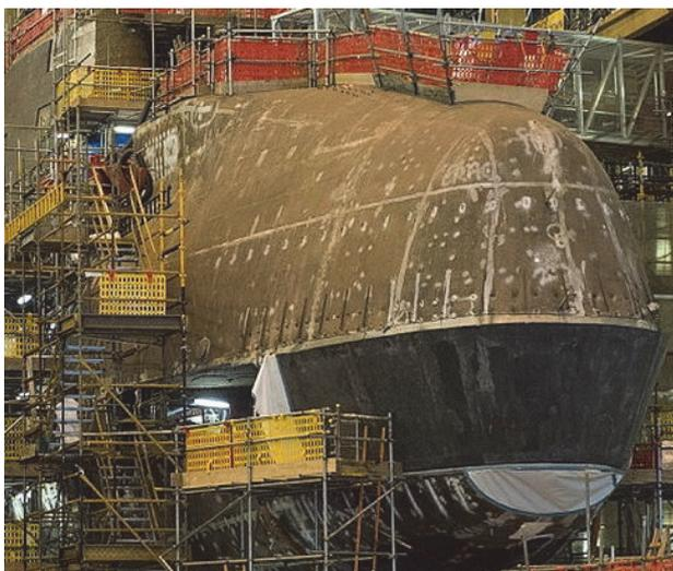
**Рис. 7.** Конструирование корпуса подводной лодки из сегментов развертываемой обшивки (Crown Copyright 2013, фото Э. Линнетта, www.defenceimages.mod.uk, фото 45155780.jpg)
