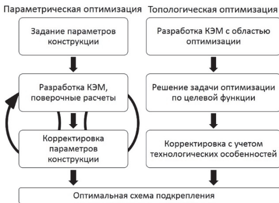
Рис. 1. Разработка схемы подкрепления отражающей обшивки рефлектора методами параметрической и топологической оптимизации
