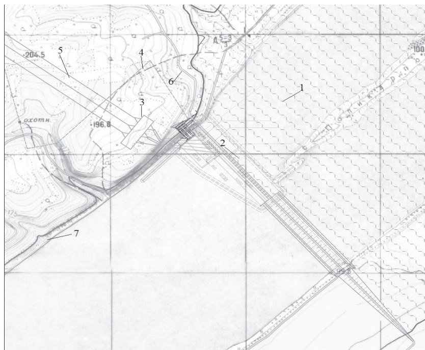
Рис. 2. Стройгенплан Мотыгинской ГЭС в Поликарповском створе: 1 — водохранилище; 2 — плотина; 3 — ОРУ 220 кВ; 4 — ВЛ 35 кВ Мотыгино-ГЭС (25 км); 5 — ВЛ 220 кВ Раздолинск-ГЭС (35 км); 6 — автодорога ГЭС-Мотыгино; 7 — причал
