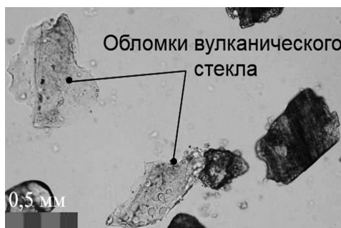
Рис. 5. Микрофотография обломочной фазы (обр. 201/1). Видны обломки пористого, неизмененного вулканического стекла. Снято в проходящем свете
