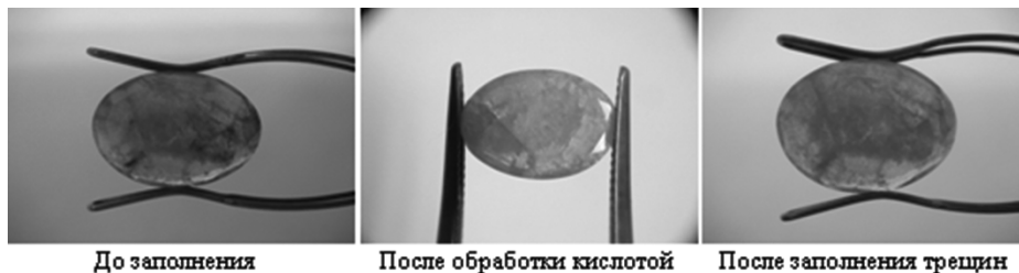
Рис. 4. Ограненный изумруд до и после облагораживания [4]
