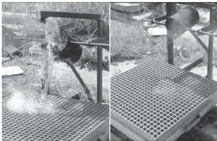
Рис. 2. Устройство для самотушения горящих при проливах жидкостей (Automatic fire-fighting system applied in case of inflammable liquid spills)
