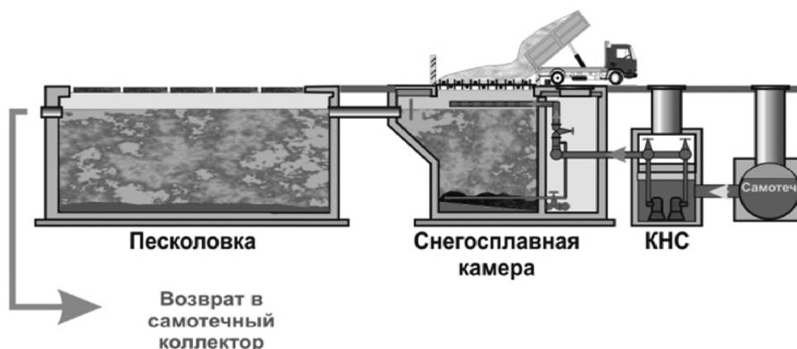
Рис. 1. Стационарное снегоплавильное сооружение на канализационном коллекторе
