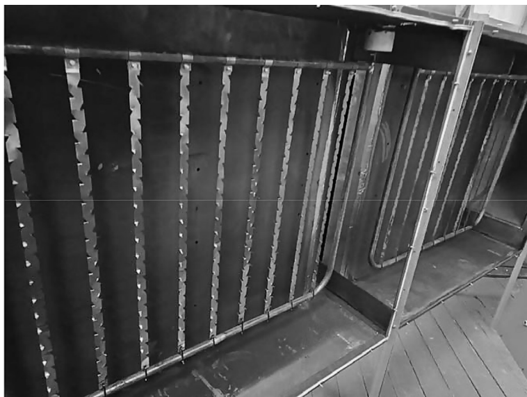
Рис. 1. Лабораторный электрофильтр со снятым осадительным электродом
