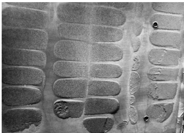
Рис. 4. Фотография структуры осажденной пыли в лабораторном электрофилтре
