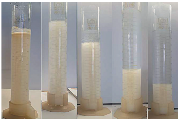
Рис. 1. Процесс коагуляции в лабораторных при оптимальных параметрах (морская вода 7,5 % + 130 мг/л 10 % раствора карбоната натрия, температура 42 °С)
