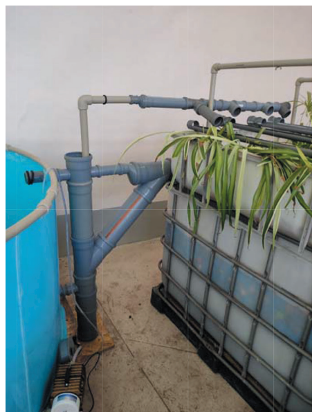
Рис. 1. Вермибиофильтрационный модуль очистки оборотной воды в РАС:
