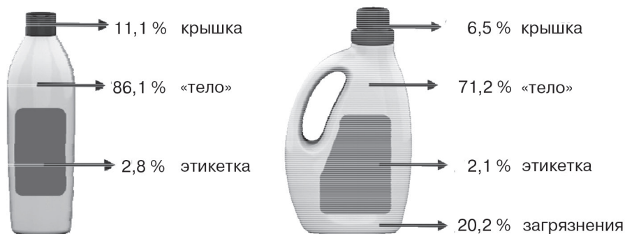
Рис. 3. Компонентный состав некоторых видов тары ПНД с закручивающейся крышкой, % по массе Источник: составлено С.В. Польшгаловым, Г.В. Ильных.
