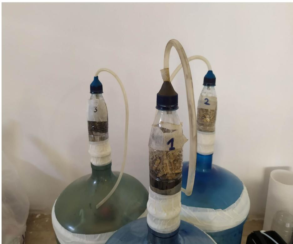
**Рис. 2.** Общий вид биосорберов с органической загрузкой
