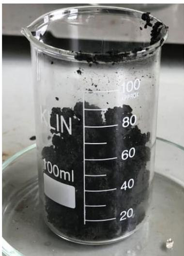
**Рис. 2. Осадок от канализационных очистных сооружений**
